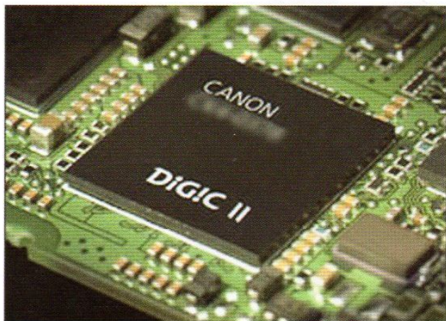
Izquierda El procesador Digic II de Canon forma parte de los modelos EOS-1D Mark II y EOS-20D. Los procesadores más rápidos, como este, reducen los retrasos del obturador y aumentan la velocidad de captura de fotografías.
